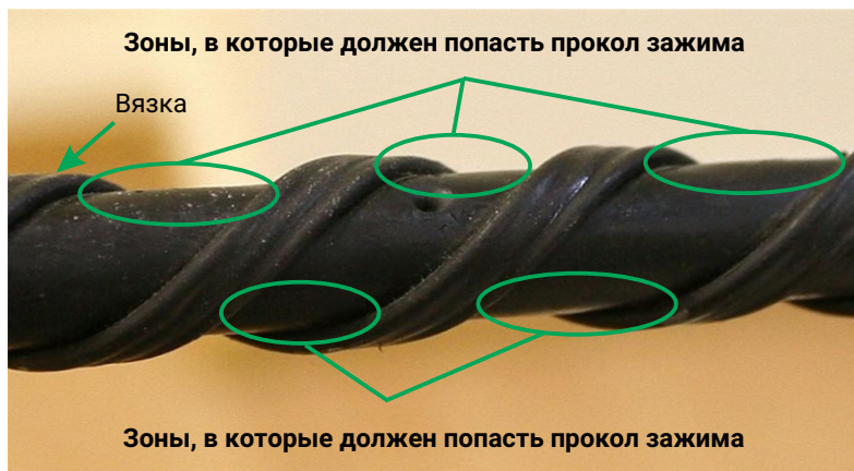
Рисунок 6 - Верное место расположения на проводе прокола зажима
