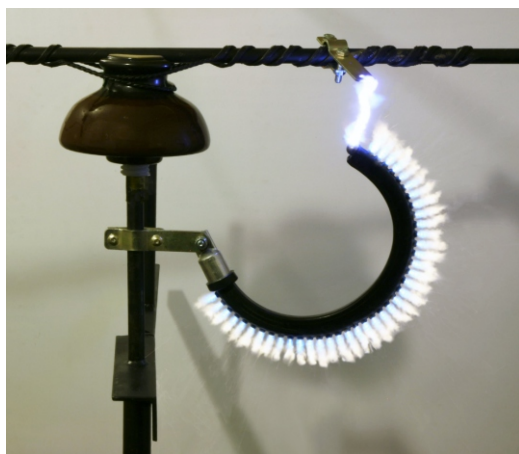
Рисунок 9 - Фотография разрядника при срабатывании
